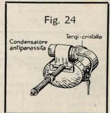
Anche il motorino del tergi-cristalli può dare adito a qualche disturbo. Basta qui un semplice condensatore (figura 24). Diverse ditte si sono specializzate nella fabbricazione di mezzi di protezione antiparassiti, facilmente applicabili nelle automobili, e dispongono di una particolare esperienza in questo campo. Anche nel-
