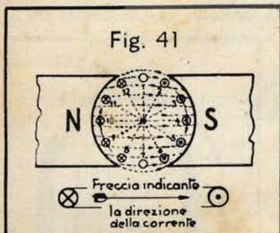
rotazione e spostandosi da 2 a 3 la metà della spira taglia un numero maggiore di linee di forza, e più ancora mentre passa da 3 a 4 e da 4 a 5. Poi il numero delle linee di forza tagliate diminuisce di nuovo, finché nella posizione 7 la spira si muove parallelamente alla direzione delle linee di forza e quindi non ne taglia alcuna.
