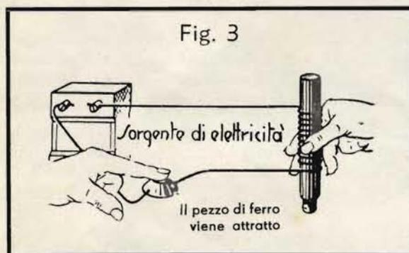
chè le calamite sono sempre magnetizzate. Negli elettromagneti, per magnetizzare il ferro bisogna ogni volta chiamare in aiuto la corrente elettrica. Invece le calamite sono sempre magnetizzate; si chiamano « magneti permanenti ».
