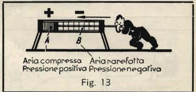
« più » da una parte ed il « meno » dall'altra si sono compensati (fig. 14). La compensazione delle pressioni avviene però con qualche oscillazione pendolare, nel senso che il pistone oltrepasserà dapprima la posizione mediana, provocando per breve tempo una sovrappressione a destra ed una depressione a sinistra. I fenomeni che avvengono durante la compensazione delle cariche elettriche di un condensatore sono molto simili.
