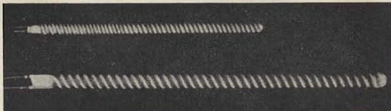
filamento nell'interno del tubetto di nichel. Quest'ultima condizione è importante, poichè eventuali vibrazioni del filamento sarebbero causa di rumori di disturbo.
