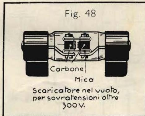
Quando una linea aerea si carica per effetto atmosferico, si formano spesso tensioni rilevanti che possono talora arrecare danni.
