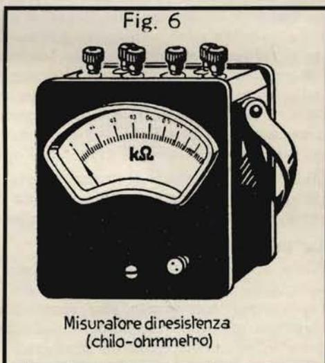
Esistono inoltre strumenti per la misura di resistenze più elevate, i cosiddetti « chiloohmmetri » (fig. 6) e « megaohmmetri ». Questi strumenti richiedono l'allacciamento di una sorgente esterna di determinata tensione.
