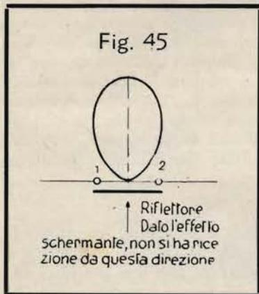
Il risultato ottenuto col riflettore è rappresentato nella fig. 45. La parte posteriore della caratteristica è eliminata, mentre la forma della curva si è modificata solo pochissimo.
