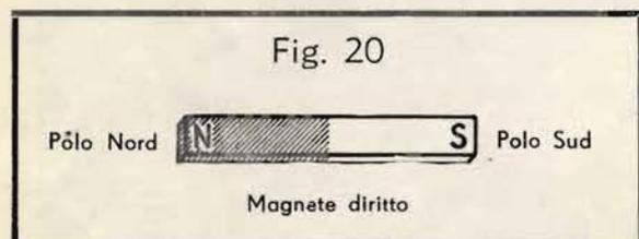
Oltre alle *calamite a ferro di cavallo*, che voi conoscete, esistono anche delle *calamite diritte* (fig. 20); queste si possono pensare formate raddrizzando una calamita a ferro di cavallo (fig. 21). La forza di attrazione delle due estremità di un magnete dritto è la stessa. Le due estremità si chiamano poli del magnete. Uno dei poli si chiama polo nord e l'altro polo sud.
