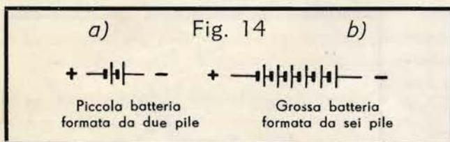
Nella fig. 14-a trovate il simbolo di una piccola batteria formata da due pile; nella fig. 14-b si tratta di una grossa batteria formata dal collegamento di parecchie pile.
